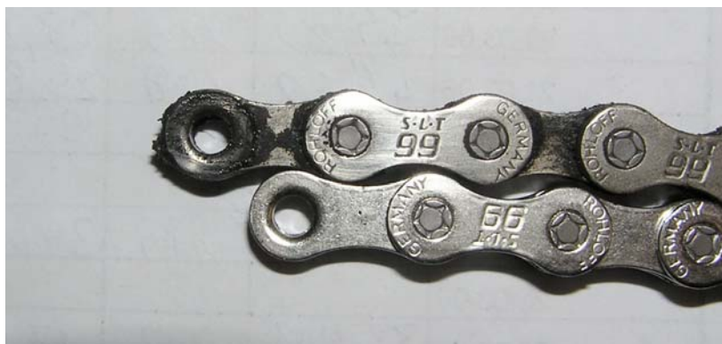
Gesamte Längendifferenz einer Kette mit über 8400 Kilometer Laufleistung gegenüber einer neuen Kette
